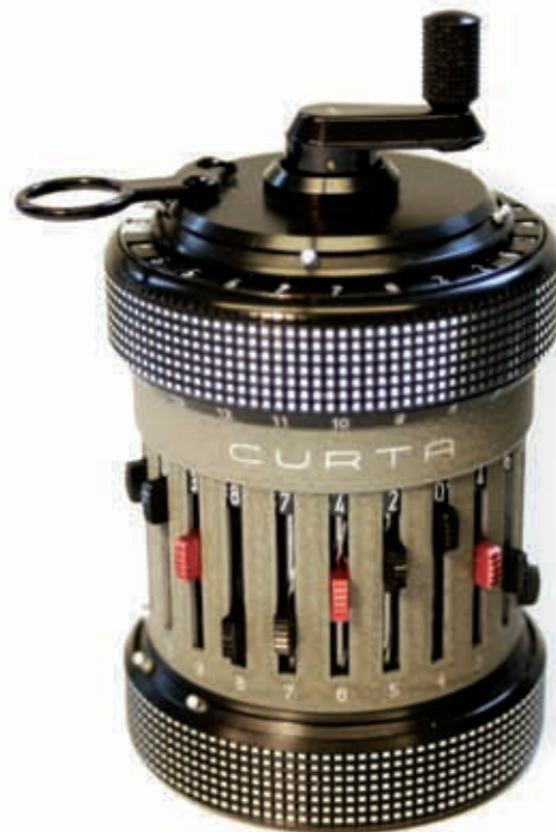
Abb. 4 Die kleinste je gebaute mechanische Rechenmaschine, die ab 1954 hergestellt wurde: die „Curta“ (Type II – System Curt Herzstark).
